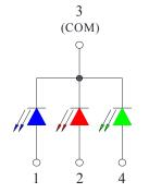
1 ANODE BLUE 2 ANODE RED 3 COMMON CATHODE 4 ANODE GREEN
